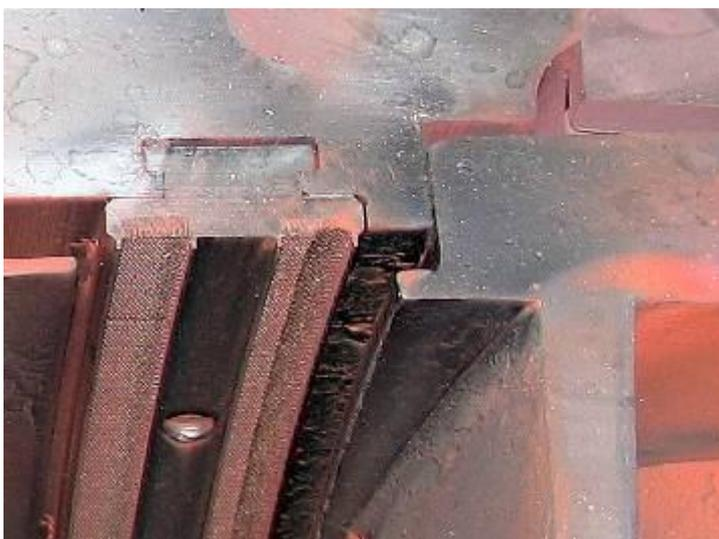
6. **Уплотнение 8 ступени:** на 1-й сотовой дорожке кольцевая выработка на входе, глубина выработки до 0,5мм, ширина - до 0,4 ширины дорожки. На 2-й сотовой дорожке кольцевая выработка на входе, глубина выработки до 0,2мм, ширина - до 0,2 ширины дорожки.
