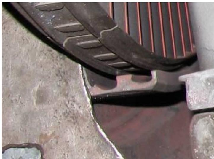
2. Полное отсутствие козырька нижней половины направляющего аппарата 13 ступени на секторе около 160° с левой стороны разъёма.
