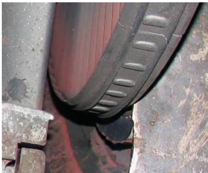
3. Подрез выходных кромок лопаток (по периферии) направляющего аппарата 13 ступени в результате размыва паром.
