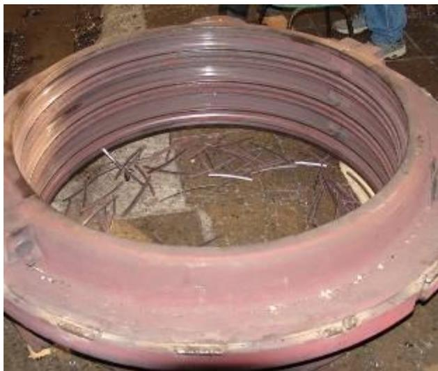
**Фото 1. Демонтаж уплотнительных корытообразных вставок типа Х-6**
