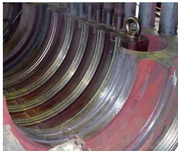
**Фото 8. Сборка проточной части с установленными сотовыми уплотнениями**
