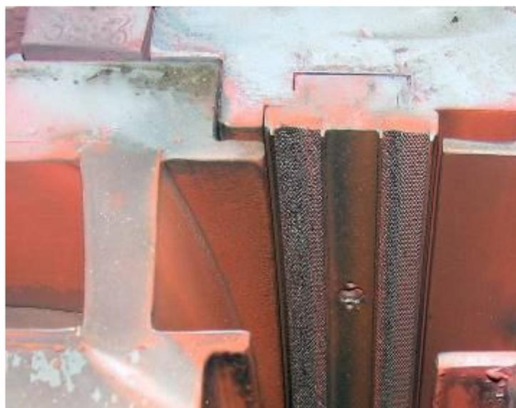
2. **Уплотнение 4 ступени:** на 1-й сотовой дорожке кольцевая выработка на входе, глубина выработки до 1,3мм, ширина - до 0,55 ширины дорожки. На 2-й сотовой дорожке кольцевая выработка на входе, глубина выработки до 1,0мм, ширина - до 0,4 ширины дорожки.
