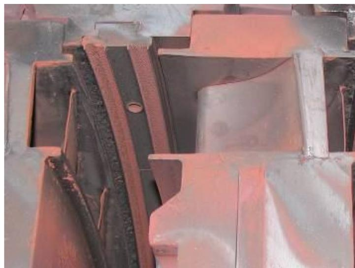
4. Деформация выходных кромок на всех направляющих лопатках 2, 10 и 11 ступеней.
