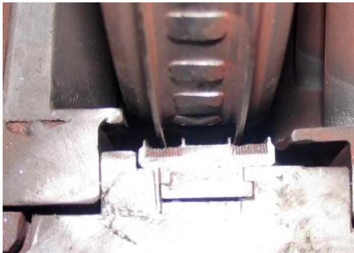
7. **Уплотнения 9-12 ступени:** Состояние хорошее. Практически полное отсутствие следов выработки.
