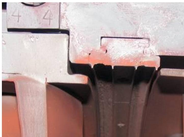
3. **Уплотнение 5 ступени:** на 1-й сотовой дорожке кольцевая выработка на входе, глубина выработки до 1,6мм, ширина - до 0,7 ширины дорожки. На 2-й сотовой дорожке кольцевая выработка на входе, глубина выработки до 1,2мм, ширина - до 0,4 ширины дорожки.
