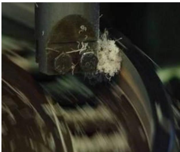
**Фото 7. Расточка сотовых поверхностей вставок, установленных на узлы статора**
