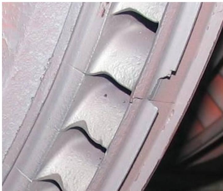
2. Имеются подрезы выходных кромок 25-35% рабочих лопаток регулирующей ступени в результате размыва паром, незначительные механические повреждения отдельных лопаток.
