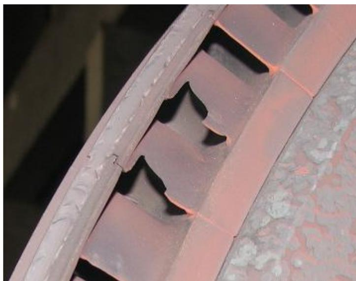
3. Механические повреждения на входной кромке бандажа рабочих лопаток регулирующей ступени. Отдельные незначительные механические повреждения корней рабочих лопаток РС и диска в районе посадки лопаток со стороны паровпуска.
