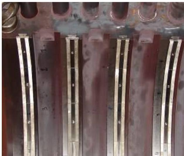
**Фото 6. Установка сотовых вставок на доработанные узлы статора**
