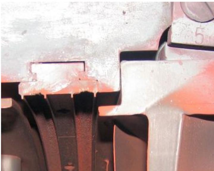
4. **Уплотнение 6 ступени:** на 1-й сотовой дорожке кольцевая выработка на входе, глубина выработки до 1,5мм, ширина - до 0,8 ширины дорожки. На 2-й сотовой дорожке кольцевая выработка на входе, глубина выработки до 0,8мм, ширина - до 0,6 ширины дорожки.
