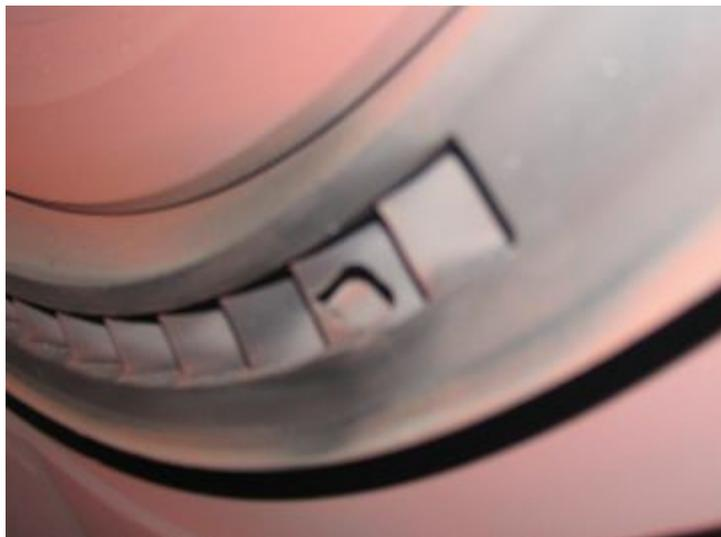
2. Отсутствие корытообразных уплотнительных вставок типа Х6 в обойме надбандажного уплотнения регулирующей ступени.
