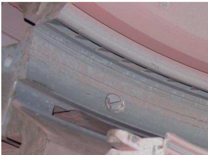
3. Деформация выходных кромок части направляющих лопаток 4, 6, 7, 9 и 12 ступеней.
