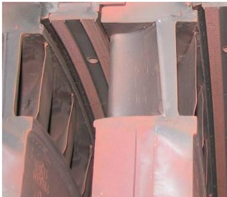
5. В периферийной части направляющих лопаток 10, 11 и 12 ступеней незначительные размывы выходных кромок.
