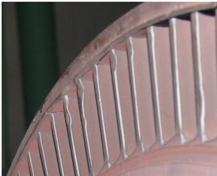
6. Незначительные механические повреждения входных кромок части рабочих лопаток 7 ступени РВД.
