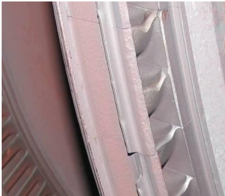
5. Механические повреждения входных кромок части рабочих лопаток и бандажа 2 ступени РВД.
