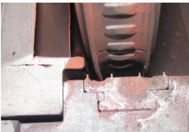
5. **Уплотнение 7 ступени:** на 1-й сотовой дорожке кольцевая выработка на входе, глубина выработки до 1,8мм, ширина - до 0,6 ширины дорожки. На 2-й сотовой дорожке кольцевая выработка на входе, глубина выработки до 0,2мм, ширина - до 0,2 ширины дорожки.
