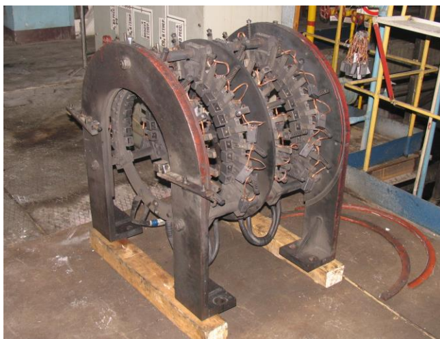
Демонтаж штатного ЩКА
