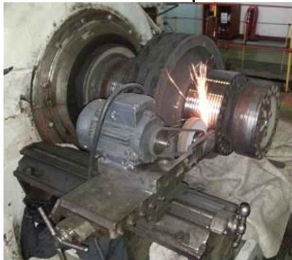
Проточка и шлифовка контактных колец
